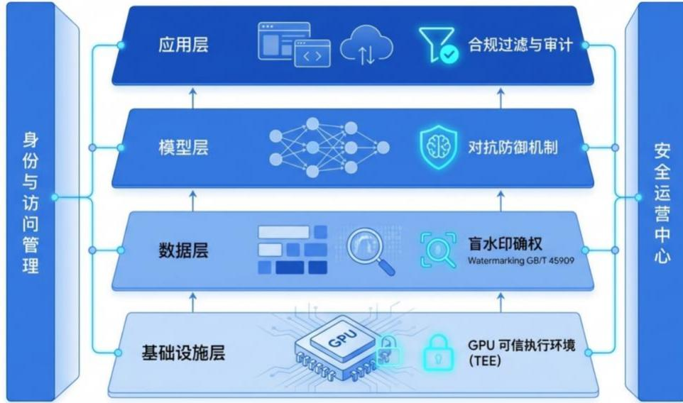
该架构展示了四层防御体系的协同工作。底层利用GPU TEE保障算力可信，数据层通过盲水印确权，模型层内置对抗防御机制，应用层实施合规过滤。
