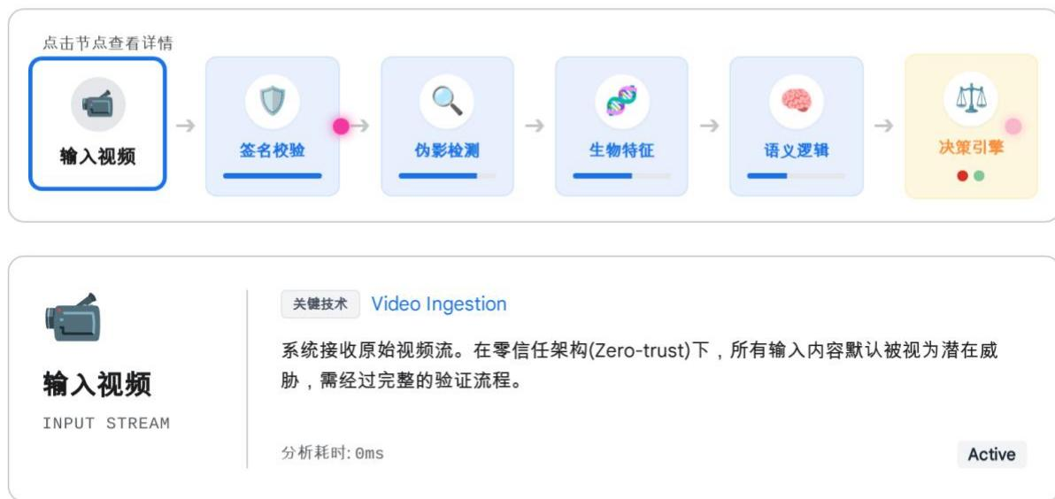
该流水线结合了底层信号分析与高层语义理解。第一阶段进行元数据与数字签名校验 (C2PA)；第二阶段利用rPPG技术检测生物特征异常；第三阶段通过LLM分析内容逻辑，最终输出综合风险评分。
